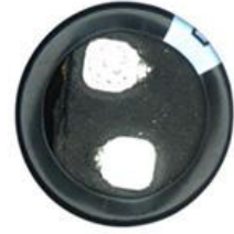
皮头盖板破损
