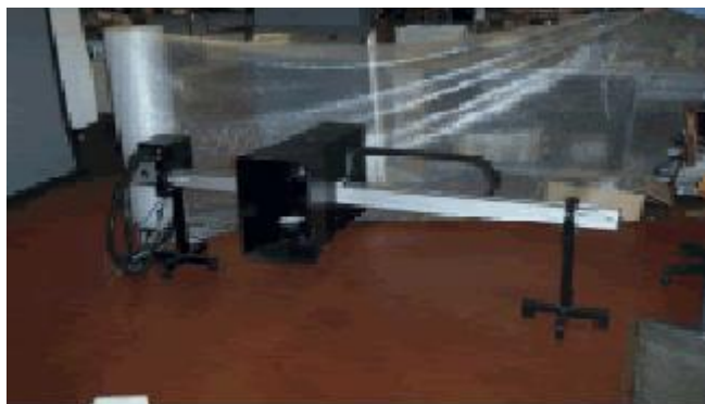
图2：自动检测在塑料上的一行字符
