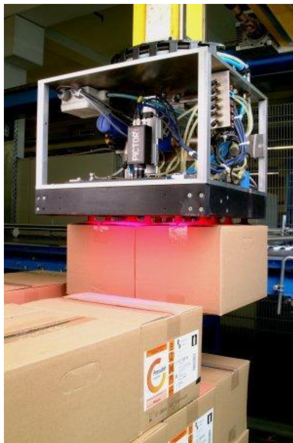
图3：视觉带动机器人的分类搬运
